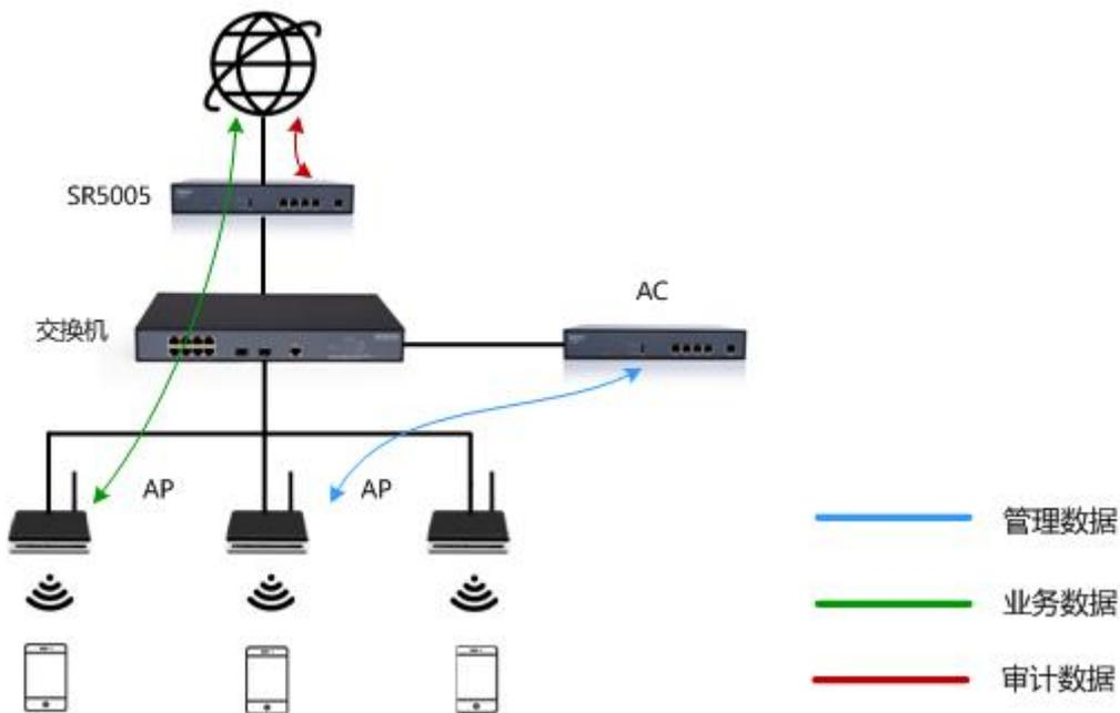
SR5005切换至旁路模式，可在现有网络架构基础上，旁挂SR5005网关，从而使现有网络具有认证审计功能，无需改变现网结构，大大节约成本。
