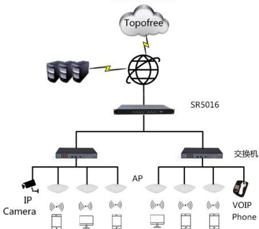
SR5016切换至旁路模式，可在现有网络架构基础上，旁挂SR5016网关，从而使现有网络具有认证审计功能，无需改变现网结构，大大节约成本。
